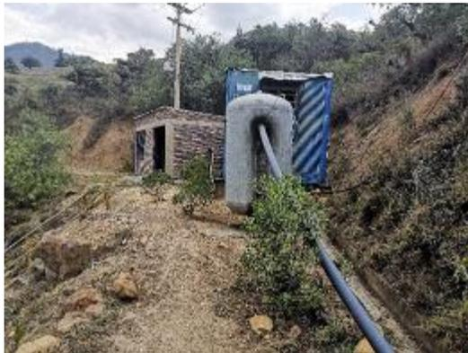
**Fotografía 5-64 Sistema de ventilación
